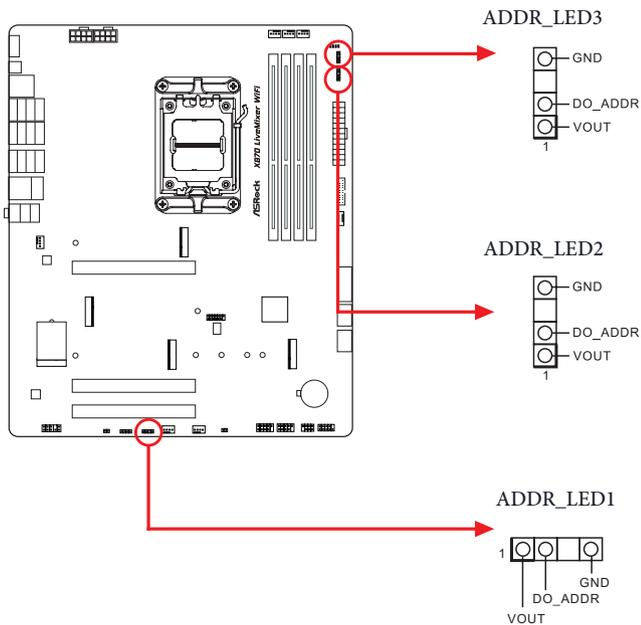
將可定址 RGB LED 燈條連接至主機板上的可定址 LED 排針 (ADDR\_LED1 / ADDR\_LED2 / ADDR\_LED3)。
