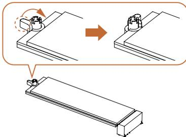
確保 M.2 SSD 末端的凹口與螺帽對齊。然後將螺帽鎖順時針轉動至鎖定位置，以固定 M.2 SSD。
